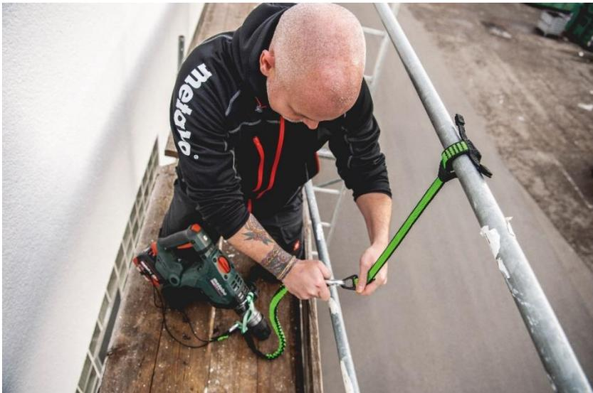
Si l'échafaudage est trop large pour le mousqueton de la sangle de sécurité, la nouvelle sangle de fixation est une solution. Celle-ci s'enroule simplement autour de l'échafaudage et le mousqueton est ensuite accroché à l'œillet qui se trouve à l'extrémité de la sangle – et l'outil est sécurisé. **Photo : Metabo**
