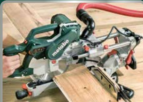
**Fonction radiale compacte** pour des pièces larges jusqu'à 305 mm
