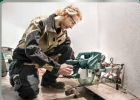
Extrêmement compacte grâce aux **barres de traction intérieures** il n'y a pas besoin d'espace derrière la scie
